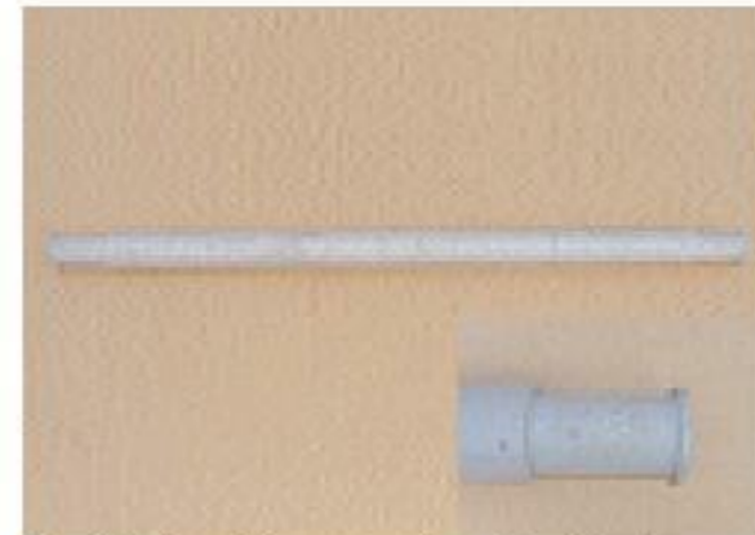
Stahlrohrwellen, ungelagert, mit eingedrehten Nuten Steel tube axles with lathed grooves without bearings
