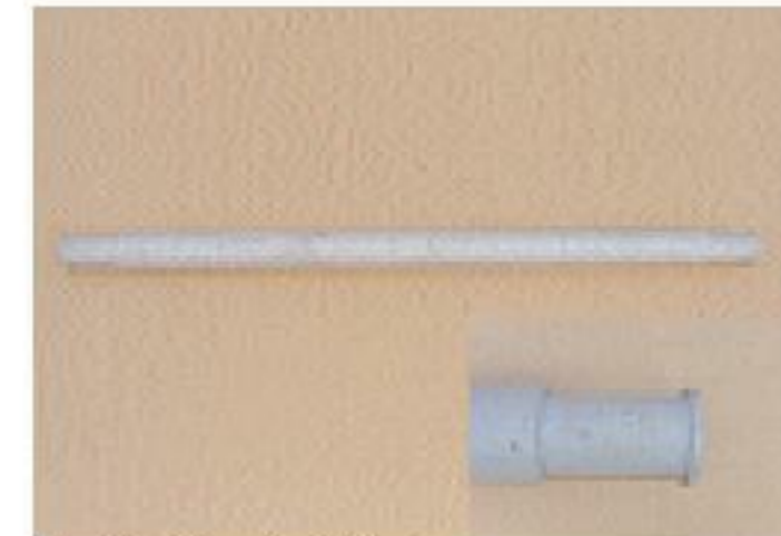
Stahlwellen als Vollachse, ungelagert, mit eingedrehten Nuten Solid steel tube axles with lathed grooves without bearings
